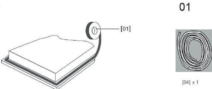
Entlang der unteren Kante des Kochfeldes müssen Sie die mitgelieferte Dichtung befestigen. Achten Sie darauf, dass sich die Enden der Dichtung überdecken.
