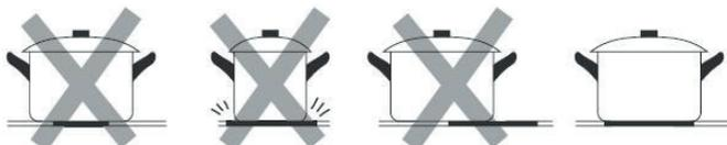
Posodo s kuhalne plošče vedno dvigajte, ne pomikajte je, da se kuhalna plošča ne opraska.
