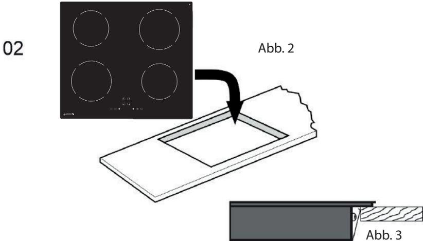
Benutzen Sie zur Befestigung des Kochfeldes zur Arbeitsfläche keinen Klebstoff. Nach der Befestigung der Dichtung legen Sie das Kochfeld in den Ausschnitt in der Arbeitsfläche. Drücken Sie sanft das Kochfeld in die Arbeitsfläche, um die Außenkanten gut zu dichten (Abb. 3).
