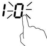
3. Pomocí tlačítka „+“ nebo „-“ můžete provést nastavení časovače v rozmezí od 1 do 99 minut.
