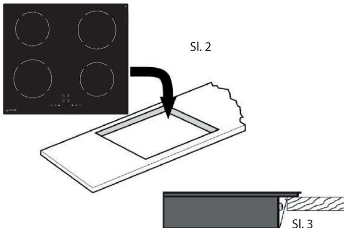
Ne uporabljajte lepila za pritrnitev kuhalne plošče na delovno površino. Po namestitvi tesnila vstavite kuhavno ploščo v izrez na delovni plošči. Nežno pritisnite navzdol na kuhavno ploščo, da jo potisnete v delovno ploščo, da dosežete dobro tesnjenje okoli zunanega roba (sl. 3).
